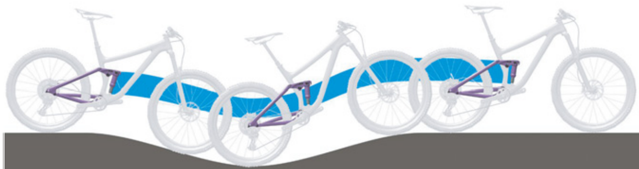
20. ábra: A hátsó lengéscsillapító optimális menetviselkedése dombos terepen
