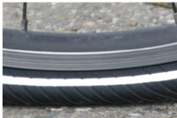
103. ábra: Túlontúl alacsony töltőnyomás
