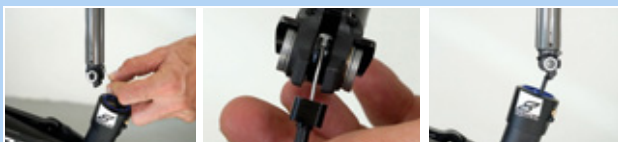
221. ábra: A nyeregcső felakasztása és betolása
