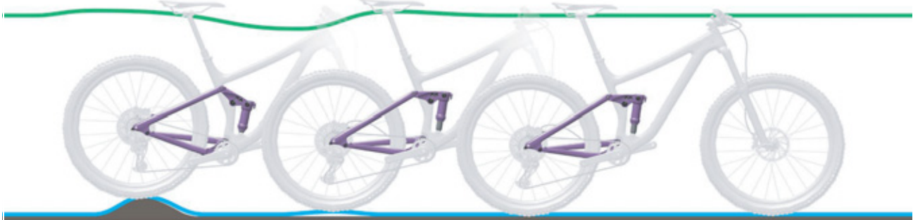
233. ábra: A hátsó lengéscsillapító túl gyors kirugózása
