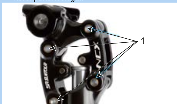
162. ábra: SR kenőpontok Suntour rugós nyeregcső
