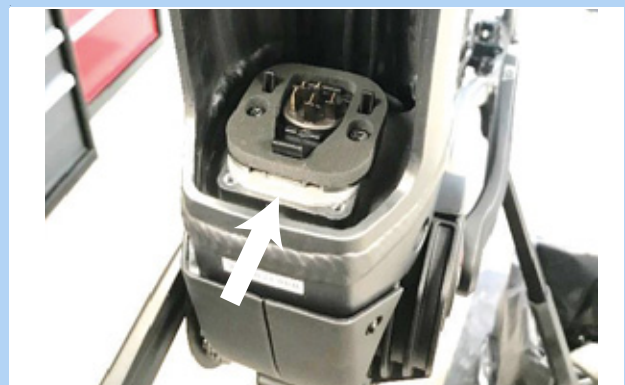
56. ábra: Beépített adapterlapok
