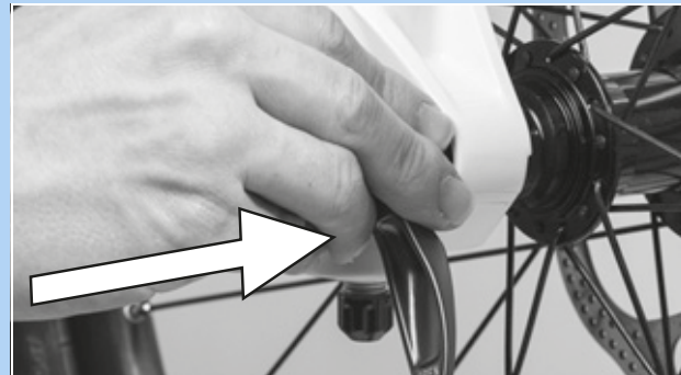
78. ábra: A gyorsár betolása nyilirányban
