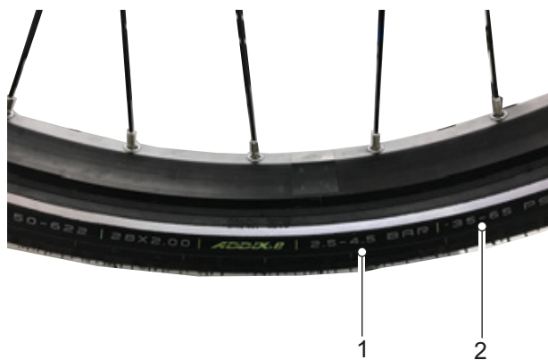
149. ábra: Guminyomás bar-ban (1) és psi-ben (2)
