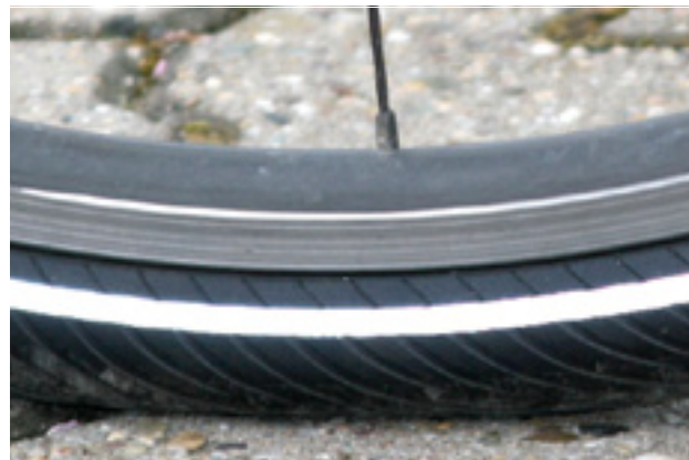
102. ábra: Helyes töltőnyomás. A gumiabroncs alakja a testsúly terhe alatt alig változik
