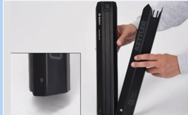
60. ábra: Az akkumulátorfedél rátolása az akkumulátorra
