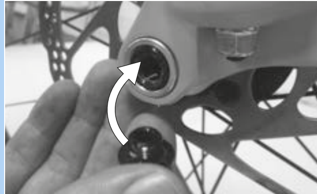
69. ábra: A gyorskioldó kar betolása a tengelybe
