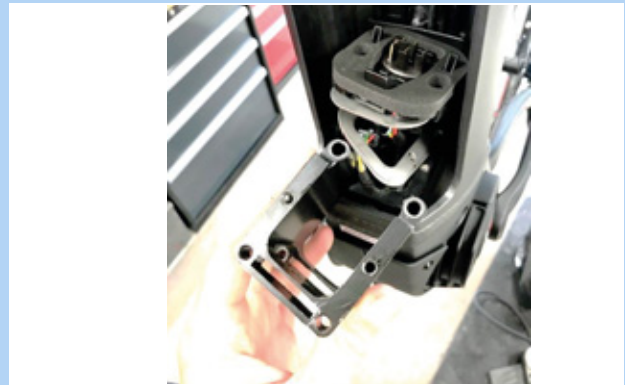
55. ábra: A PowerTube adapter kihúzása
