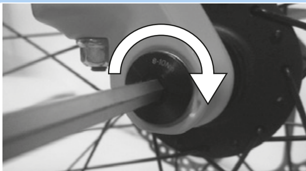
68. ábra: A tengely meghúzása nyílrányban
