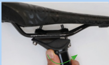
214. ábra: Magasságállítás nyitása
