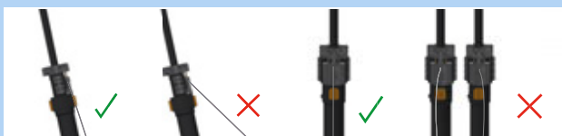
190. ábra: Helyesen és hibásan beállított bovdent
