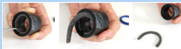
174. ábra: A filcgyűrű eltávolítása
