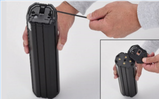
61. ábra: A felső csatlakozó felület kiszérése
